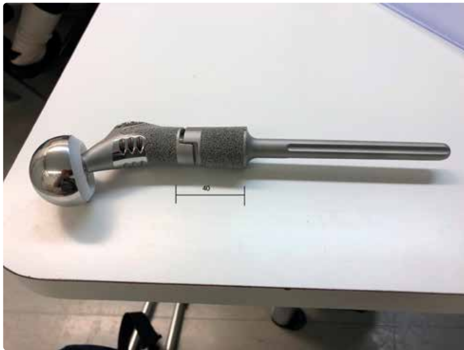
Mittoja ovat: pituus vasemmalla lonkan nivelalue lonkan pallonivel mukaan lukien 70 mm, proteesin keskiosa eli kaula 41 mm ja varsi eli reidenpuoli 125 mm eli yhteensä pituutta 236 mm. Halkaisija vaihtelee paristakymmenestä mm:stä varren noin 10 mm:iin. Materiaali on CrCo-terästä. Pallonivelessä on muovi "voitelemassa" teräsosien välissä. Oma kuva.
